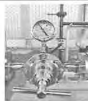
3. ค่าแรงดันการไหลของแอมโมเนียจะต้องไม่เกิน 0.1 Mpa
